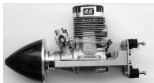
Il supporto motore dedicato (non compreso, ns cod. 335.326) è adatto sia ai motori OS 120-140 che agli YS 120-160
